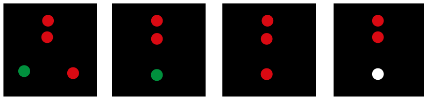
Bugansicht Steuerbordansicht Backbordansicht Heckansicht
