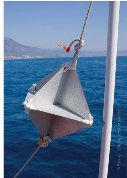
Auch auf Booten und kleinen Schiffen (z. B. Yachten, Fischerbooten) aus Holz oder Fiberglas werden Scheinwerfer angebracht, damit sie möglichst zuverlässig vom Radar erfasst werden können. Am häufigsten werden traubenförmige und achteckige Eckscheinwerfer mit einer Seitenlänge von 20 bis 40 cm verwendet.
